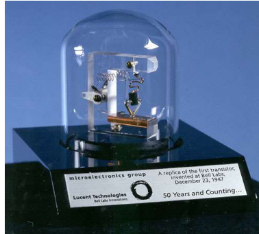
Réplique du premier transistor inventé en 1947
